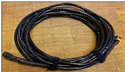
スイッチング電源とコントロールボックスを接続するためのケーブルです。長さに若干のバラつきがありますが、最低でも5mを超える長さとなります。更に延長が必要な場合は 追加の延長ケーブル をご注文ください。
