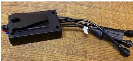
LEDスーツの動作を制御するための装置です。
