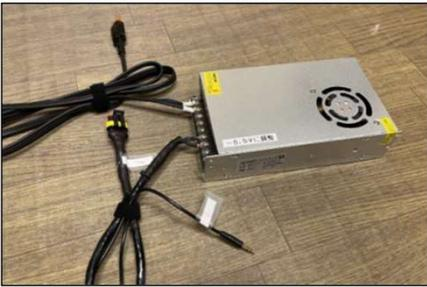
LEDスーツの電源と、衣装/音源を接続するためのハーネスセットです。
